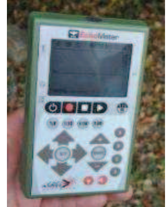
Figure 3 - Détecteur-Enregistreur d'ultrasons Echometer 3 (EM3) de chez Wildlife Acoustics
